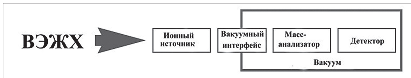
Рис. 1. Принципиальная схема LC-MS. В качестве метода ионизации здесь подразумевается химическая ионизация при атмосферном давлении
